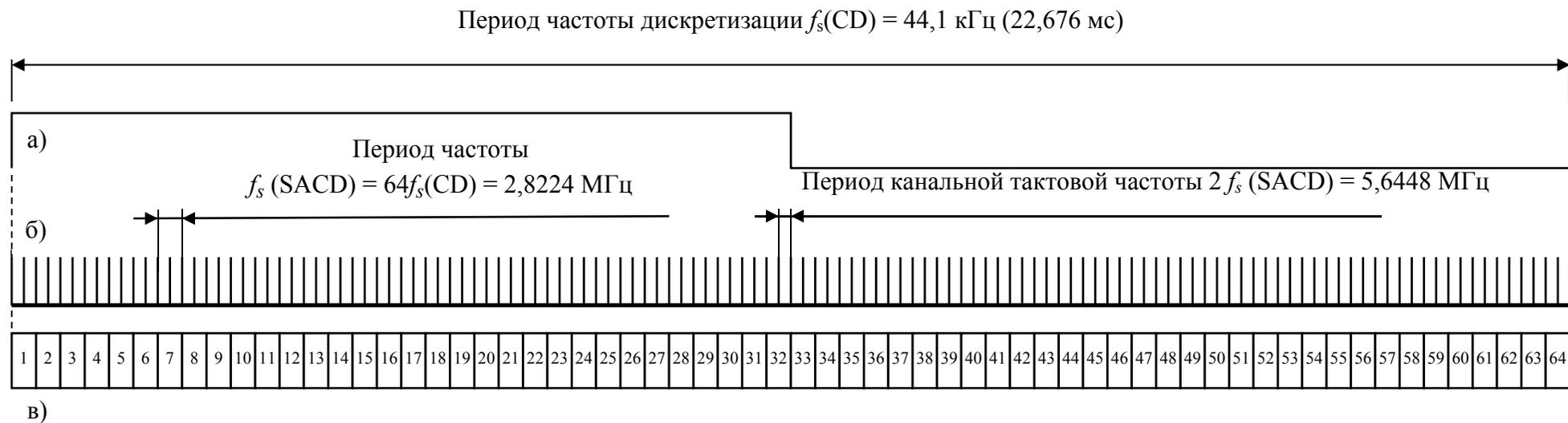
Рис. 4.4. Временные диаграммы сигналов интерфейса SDIF-3 для однократной скорости следования битов DSD:
