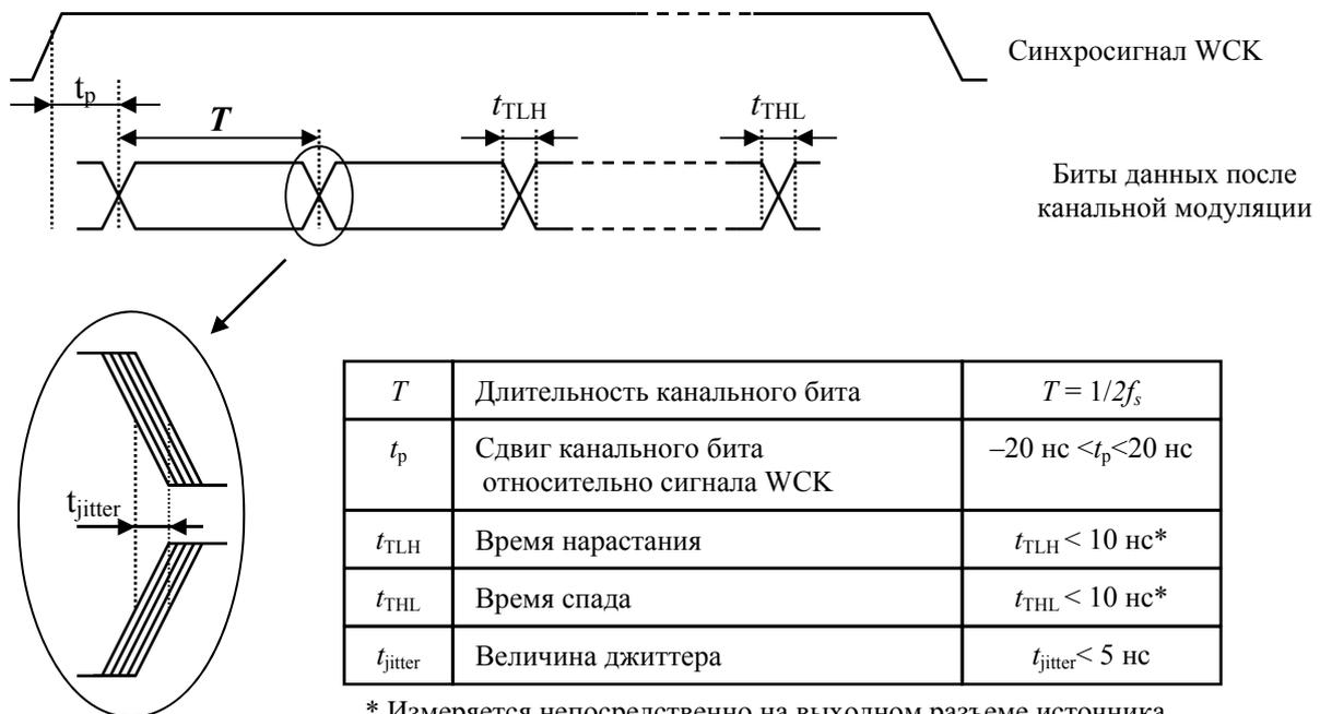
\* Измеряется непосредственно на выходном разьеме источника сигнала, когда кабель еще не подключен;  $t_{TLH} = t_{THL}$  (желательно)
