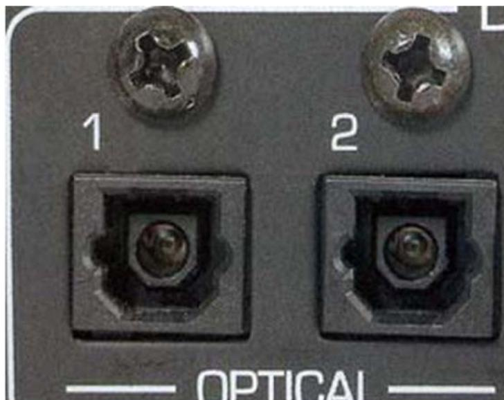
Рис. 7.6. Гнездо оптического соединителя Toslink JIS F05
